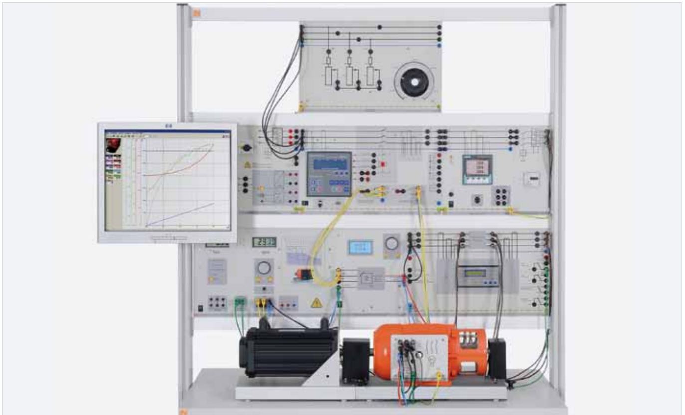
Versuchsbeispiel „Generator-Differentialschutz EGP 2“
