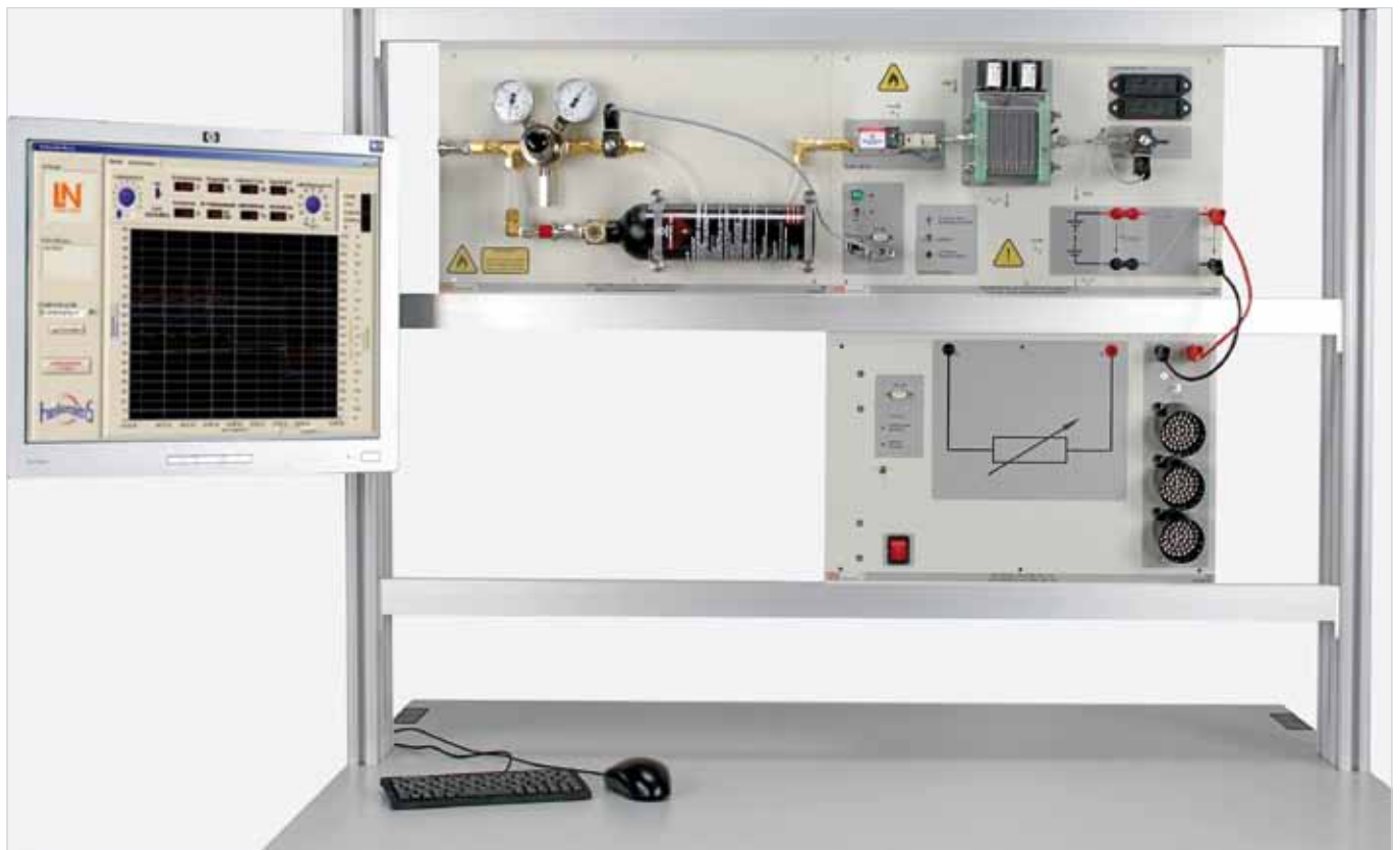
Versuchsbeispiel „50-VA-Brennstoffzellen-Stack mit Verbrauchern EHY 1“
