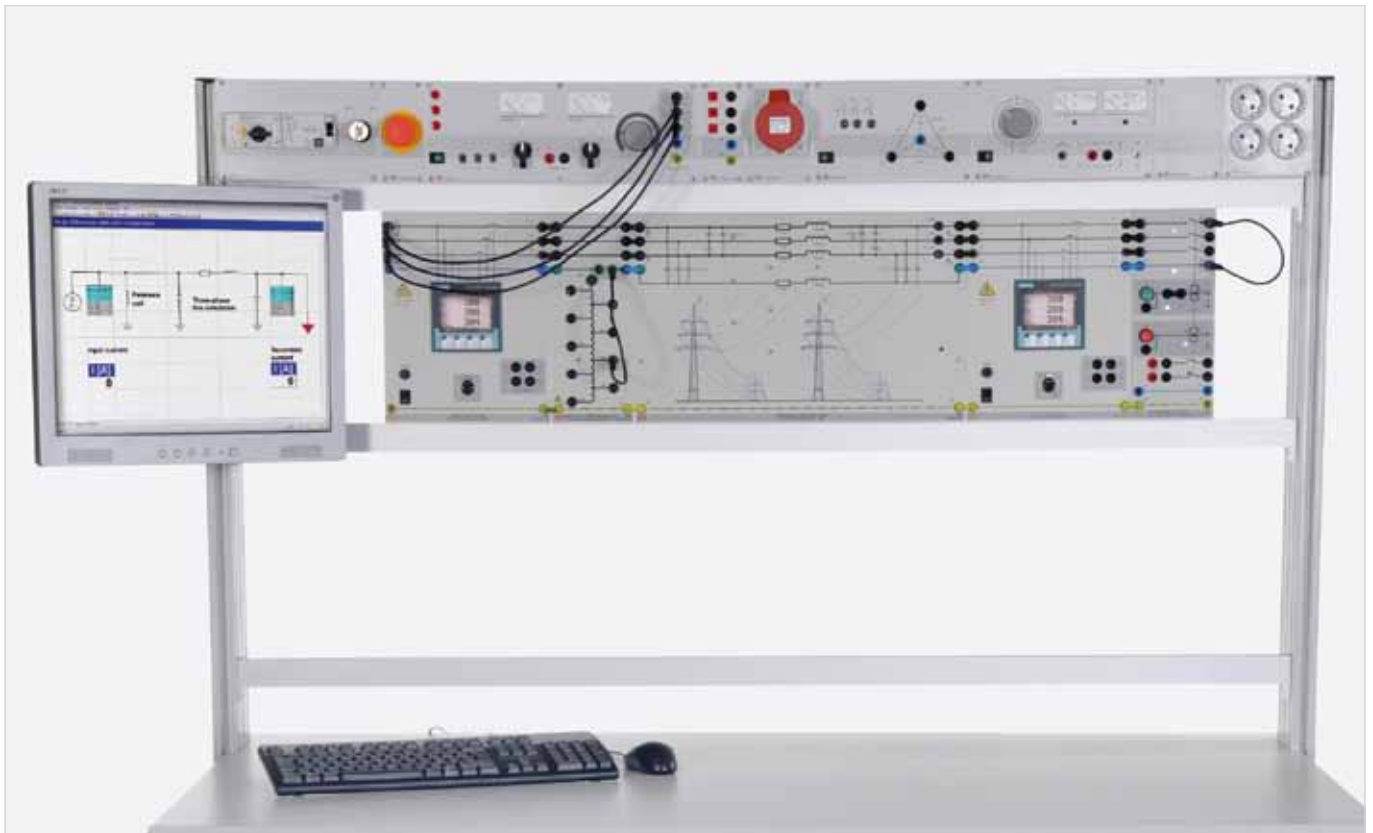
Versuchsbeispiel „Untersuchungen an Leitungen mit Erdschlusskompensation EUL 3“
