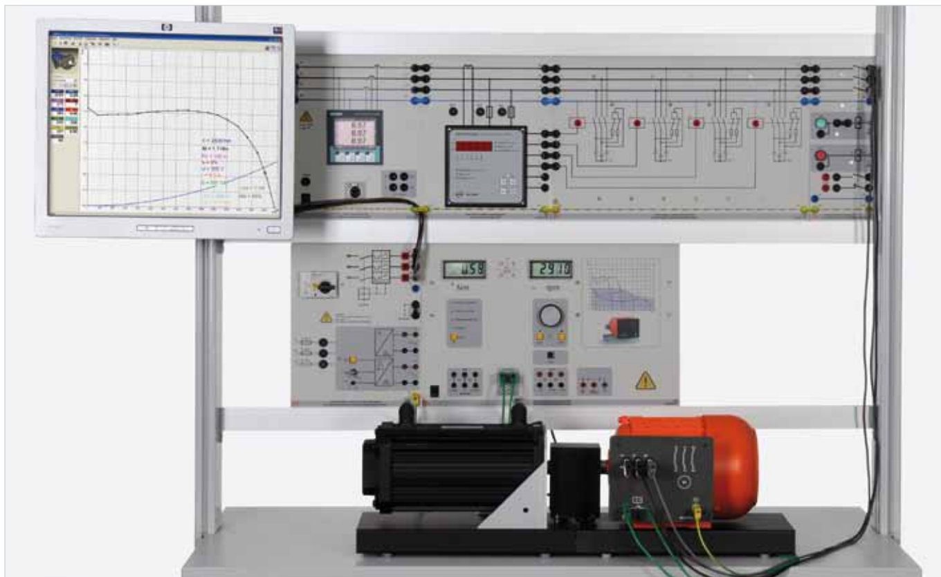
Versuchsbeispiel „automatische Blindleistungskompensation EUC 3“
