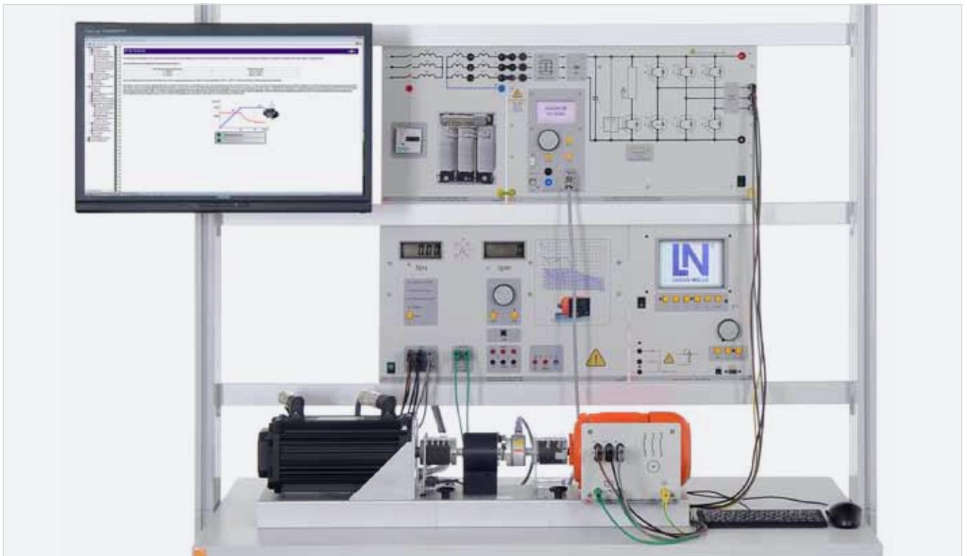
Systeme de formation « Régulation orientée champ de moteurs asynchrones avec Matlab®/Simulink® et banc d'essai de machines à servocommande »
