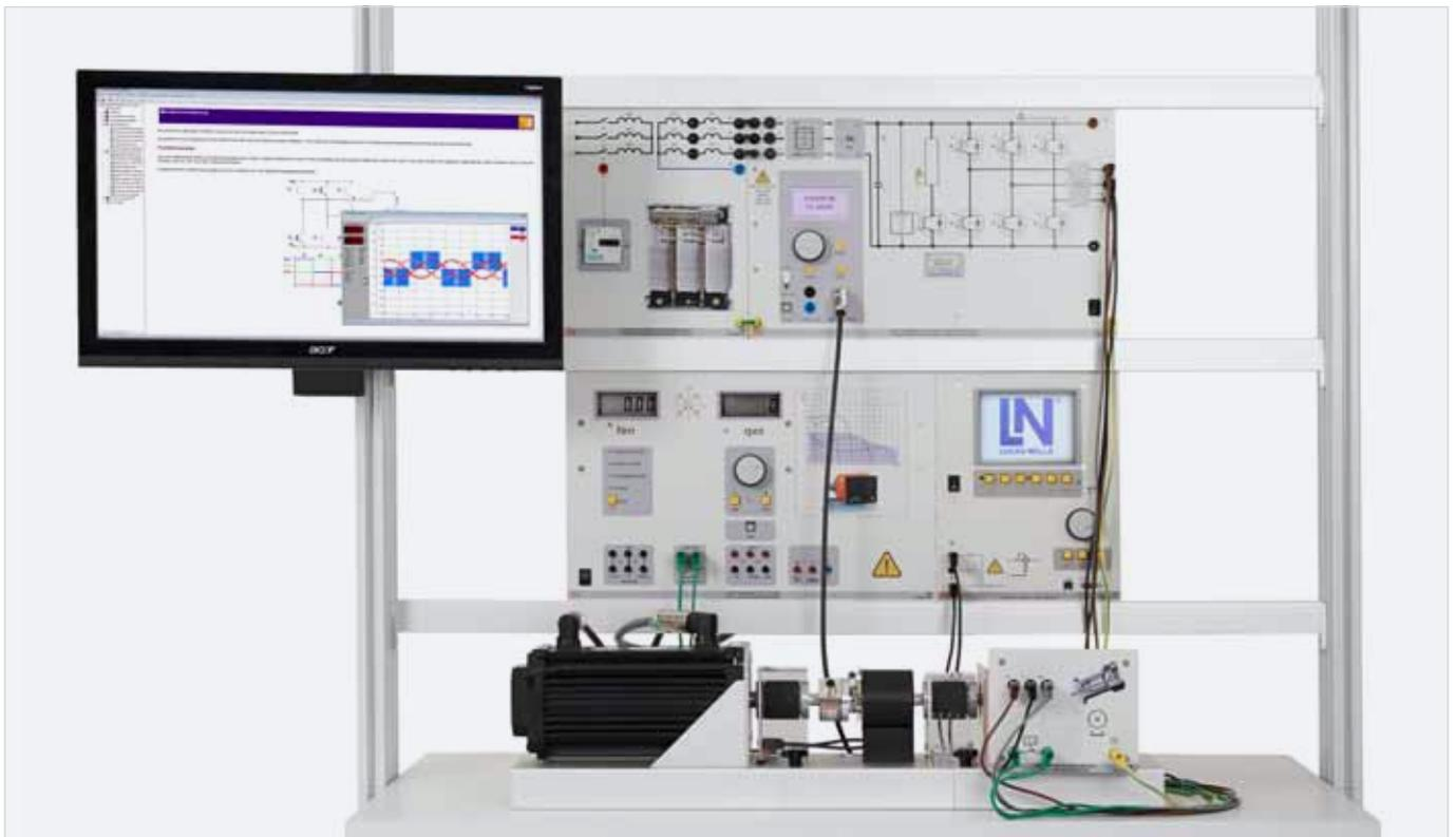
Systeme de formation « Servomoteurs avec banc d'essai de machines à servocommande »
