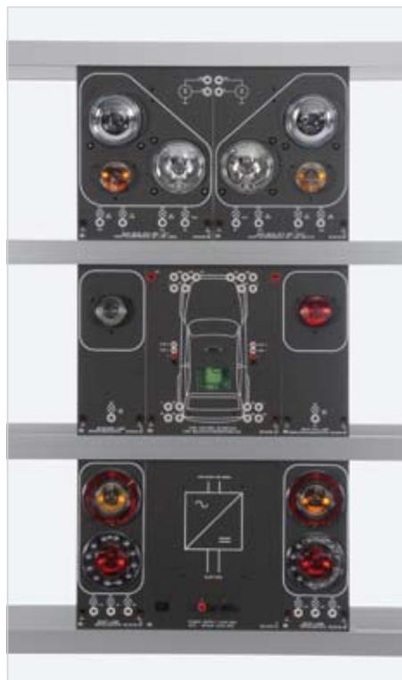
Expérience « Éclairage automobile commandé par bus CAN » avec interface SOI3216-2Z et composants additionnels
